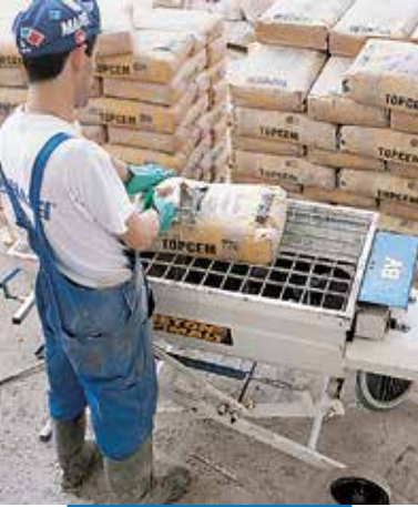
Mezcla de Topcem en mezclador con sinfín
