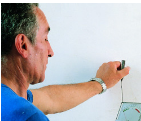
Comprobación de la humedad del yeso
