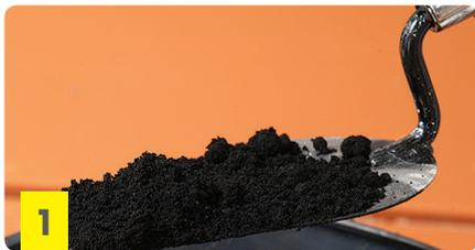
Colocar en el balde 1 parte de agua, agregar paulatinamente 6 partes de **weber country** y mezclar hasta obtener una masa húmeda granulada y homogénea.
