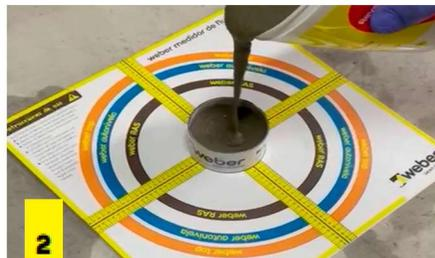
2 . Mezclar el producto con 5,5-6 litros de agua por bolsa de 25 kg con un batidor eléctrico, hasta obtener una pasta fluida y homogénea. Mantener constante esta proporción durante toda la aplicación. También puede ser mezclado con máquina proyectadora M-tec Duo Mix. Ajustar el caudalímetro a 850 l/h. Verificar la correcta consistencia de la mezcla con el medidor de fluidez.
